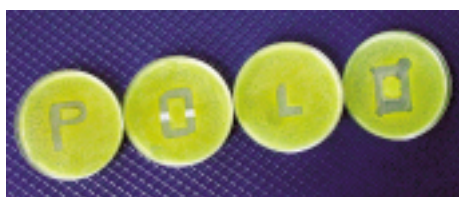
Bild 1 Petrischalen mit gelb gefärbten Kolonien des Gram-positiven Bakteriums Micrococcus luteus , einem Testorganismus, der auf der Hautoberfläche bei Menschen oder in der Luft zu finden ist. Die Buchstaben bestehen aus antibakteriell beschichteter Polyethylen-Folie und wurden nicht besiedelt. Antimikrobielle Beschichtung: Fraunhofer IAP mikrobiologische Bewertung: Fraunhofer IGB.
