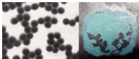
Bild 5 Monodisperser Latex (links TEM Aufnahme, rechts Lichtreflexion).
